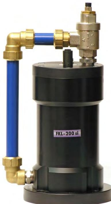
Der Klopfer wird mit einer Grundplatte ausgeliefert, die zur Befestigung des Klopfers und Übertragung des Schlagimpulses dient. Klopfergehäuse und Grundplatte sind aus Aluminium. Die Schlagplatte (in der Grundplatte integriert) ist aus schlagfestem Spezialkunststoff.
