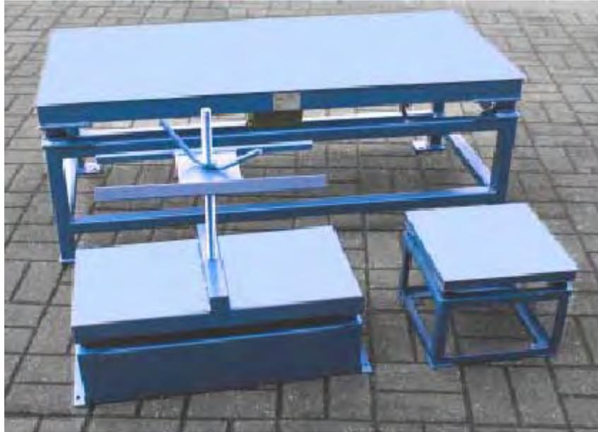
Die FTT und TCT Vibrationstische können in individuellen Größen angeboten werden. Standardmaße finden Sie auf der Folgeseite. Die Tischplatte liegt auf 4 Schwingungsdämpfern. Diese werden auf maximale Vibrationsdämpfung ausgelegt. Als Antrieb können pneumatische Vibratoren oder Vibrationsmotoren vorgesehen werden. Hiermit kann ein weiter Bereich von Anwendungen abgedeckt werden.
