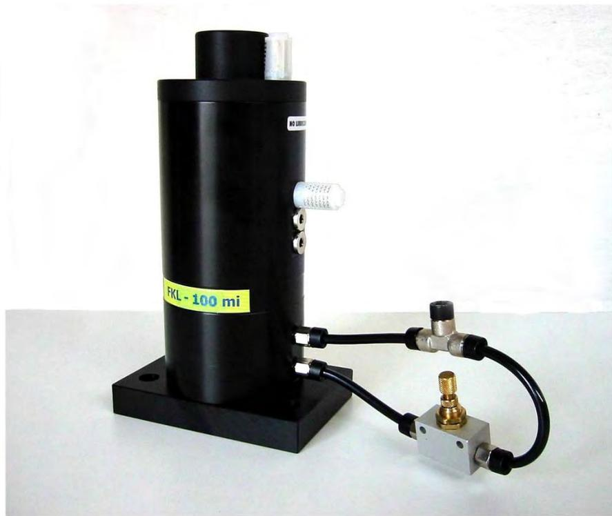
Mit Hilfe einer mitgelieferten Drossel kann der Schlagtakt des Klopfers von 1 Schlag alle 2 Minuten bis zu 2 Hz Taktung ohne zusätzliche pneumatische oder elektrische Steuerung eingestellt werden. Es ist lediglich ein Druckluftanschluß mit gefilterter Luft < 5µm nötig sowie ein Ventil, um den Intervallklopfer auszuschalten.
