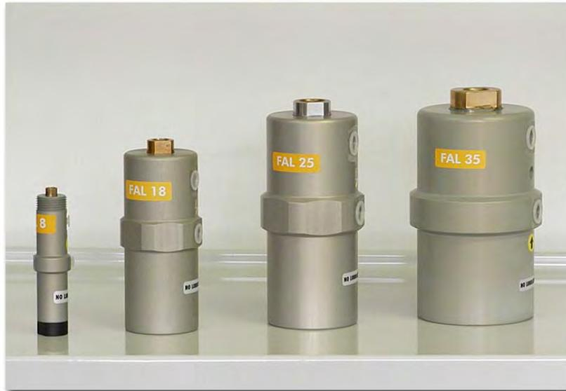
Die Kolbenvibratoren der FAL- Serie zeichnen sich durch einen freifliegenden Kolben aus, d.h. der Kolben tritt mit einer Stange aus dem Vibratorgehäuse aus. Werden die gegeneinander schwingenden Maschinen-/Gerätegruppen zum einen am Vibratorgehäuse (Boden) und zum anderen an der Kolbenstange befestigt, erzeugt der Kolbenhub (Maß "S", s. Maßskizze auf der folg. Seite) eine besonders große Amplitude mit linearer Schwingung.
