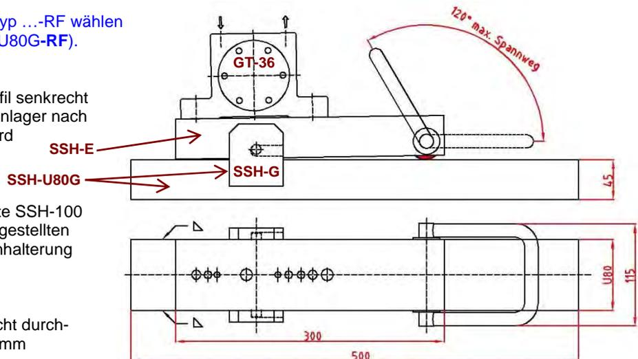
Bei Verwendung einer Anschweißplatte SSH-100 muss diese bauseits (anstelle des dargestellten Vibrators GT-36) auf die Schnellspannhalterung festgeschweißt werden.
